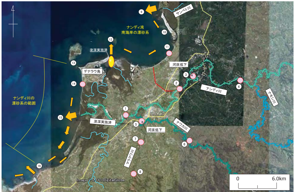
図 6-9 ナンディ川流域及び沿岸域の土砂輸送形態
