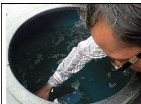
凝集層。原水に凝集剤を添加し、攪拌。
