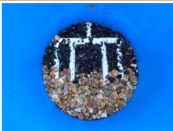
濾過槽の底部。小石と活性炭を敷く。ろ過後の水が通るパイプを敷設。この上に砂を敷く。
