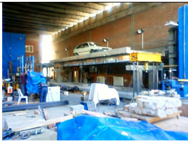
98. 中東工科大学土木工学科の実験棟内 右に車のある施設は高架高速道路の実験施設。左上の青い部分は反力壁。
