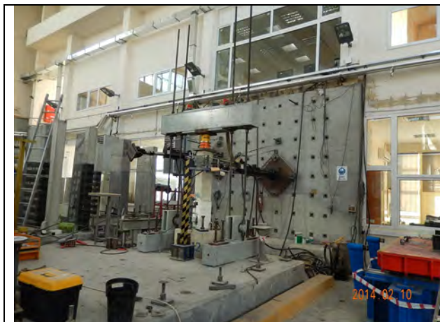
97. イスタンブール工科大学地震工学研究センター 1993年 JICA プロジェクトで建設された反力壁等の施設。今でも使用している。
