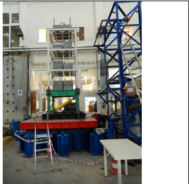
96. イスタンブール工科大学：建設中の振動台 台面(赤い部分)が3m×3m、一次元加振。設置は完了し、検証段階である。
