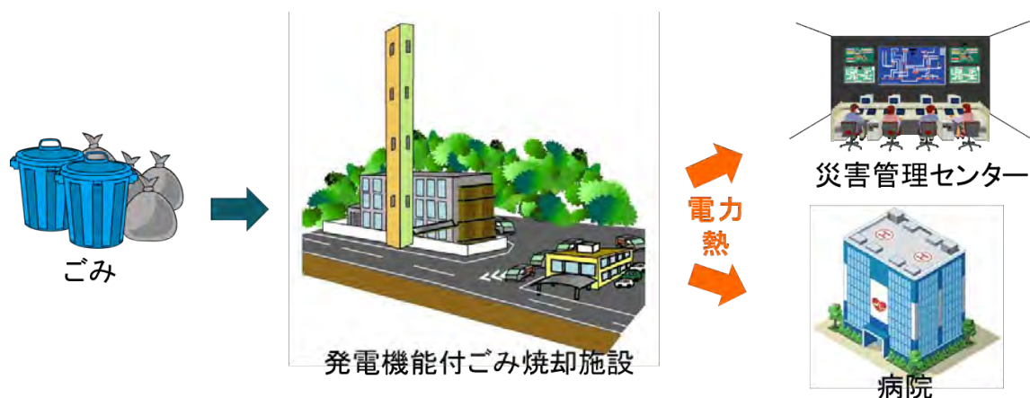
図 4.5.18 発電機能付きごみ焼却施設の機能
