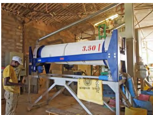
Calibreur installé dans une rizerie ; Il y fonctionne de concert avec le tamis rotatif. Février 2013 (Ross Béthio)
