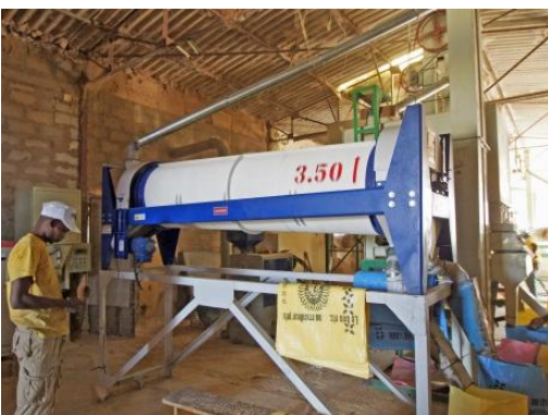
精米工場に据え付けられた長さ選別機。既存の回転式フルイと連携し、完全米と大碎米に分離している。 2013年2月 (Ross Bethio 地区)
