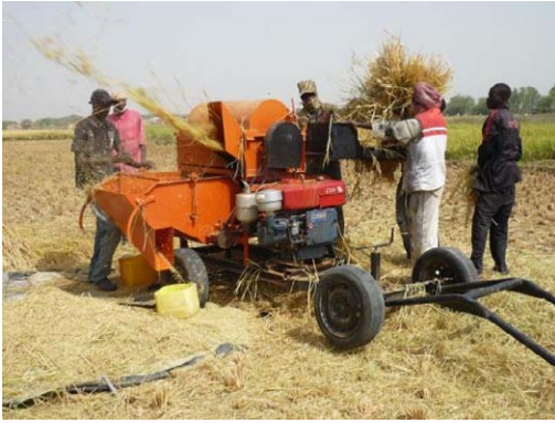
脱穀機の導入試験。操縦方法、維持管理方法に関するトレーニングも合わせて実施した。 2011年7月 (Podor, Donaye IT4 地区)
