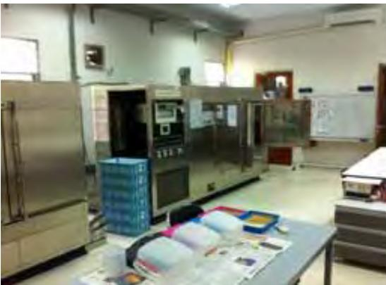
蒸熱処理 (VHT) 設備 (PFI)
