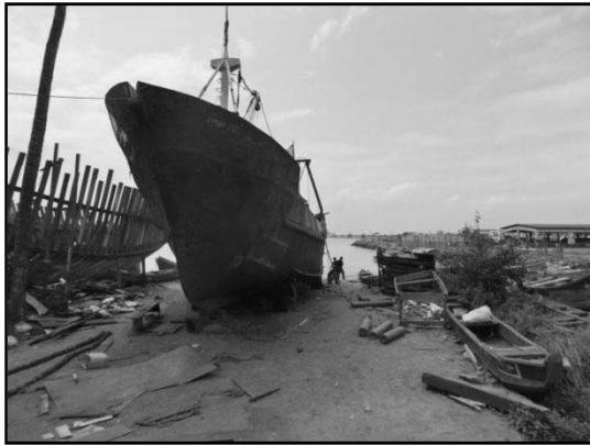
写真-38 北側ビーチでの鋼鉄船の修理状況
