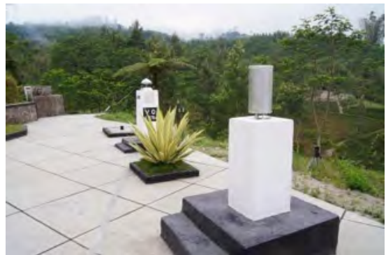
ババダン観測所の GPS (奥)、雨量計 (手前)
