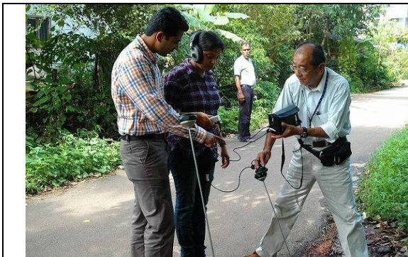
現場における漏水探知機操作指導
