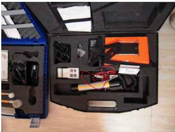
鉄筋腐食検査機 (Cover Meter with Half-Cell Potentiometer) 出典：JICA 調査団
