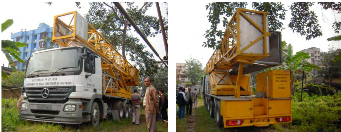
図 5.3.1 アッサム PWD が保有する橋梁点検車
