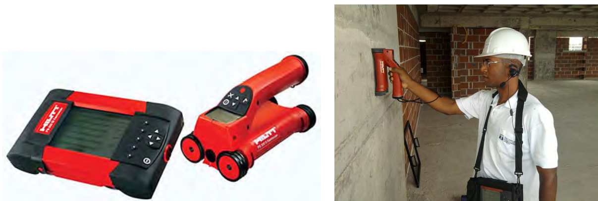
図 4.1.4 電磁誘導試験装置および電磁誘導法の測定状況
