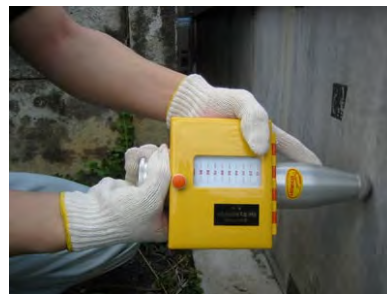
図 4.1.2 リバウンドハンマーおよびシュミットハンマー試験
