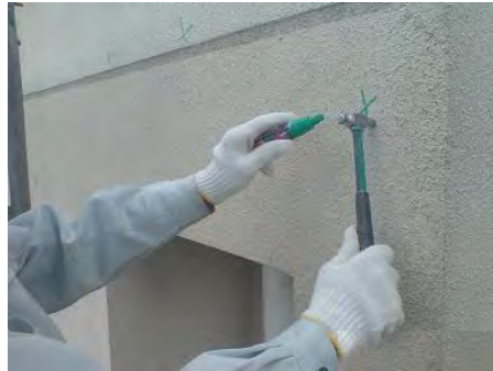
図 4.1.1 テストハンマーおよび打音検査状況
