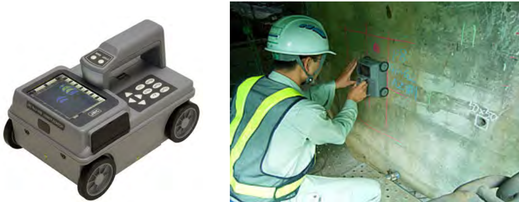
図 4.1.7 電磁波レーダーおよび電磁波法の測定状況
