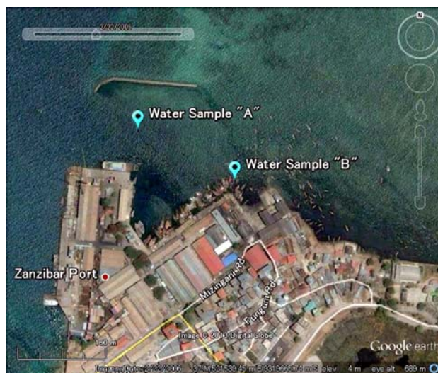
図 2-33: 水質検査の検体採取位置
