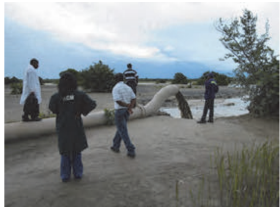
写真 4.44 尾鉱のダムへの放水（尾鉱は コンセンレーターからスラリー送水）
