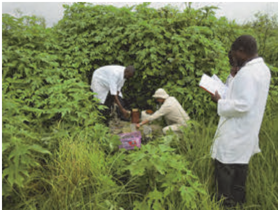
写真 4.53 モニタリング井戸での地下水採取 (旧尾鉦ダム西端 BW-3 孔)
