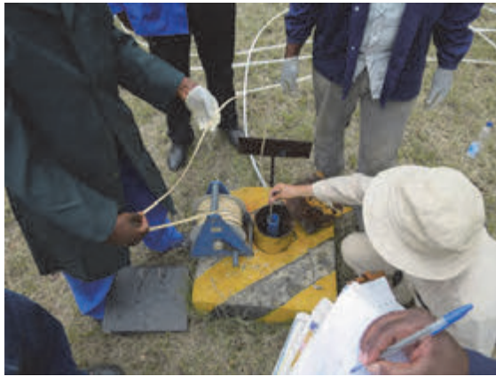
写真 4.39 水質モニタリング孔での測定 (孔は鉱山施設内外に数 10 地点存在)
