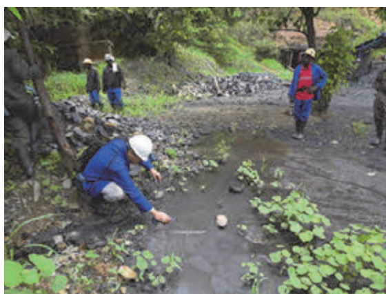
写真 4.3 坑口原鉱ストックからの排水状況
