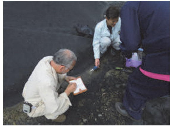
写真 4.40 Slag Dump #2 での水質測定 (降雨による水溜りが認められる)
