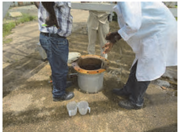
写真 4.54 旧立坑での坑内水採取 (旧鉦山施設内 Davis Shaft 孔)
