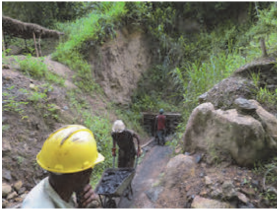
写真 4.27 坑口での運搬工
