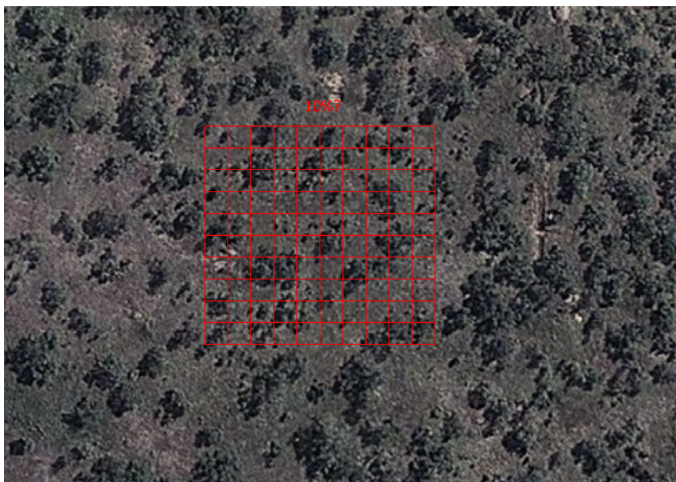
図 3-134 高分解能衛星と樹冠率の推定グリッド
