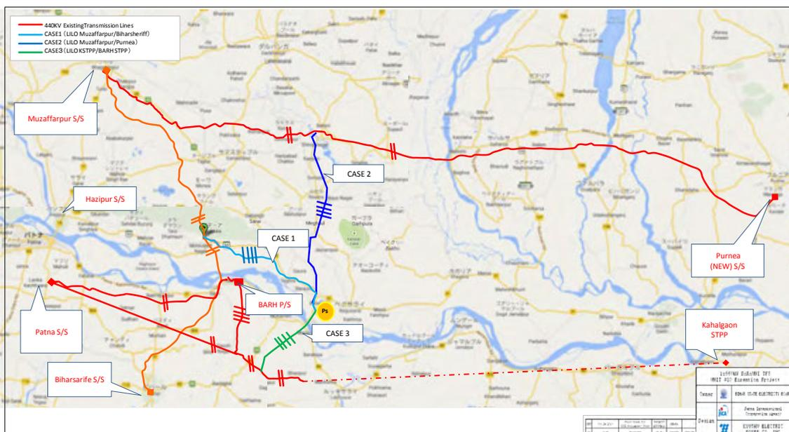
図 4.6-4 新設 400 kV 送電線の送電線ルート案 (Google 地図)
