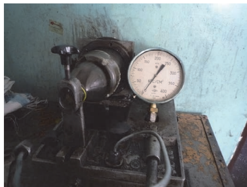
Тестер топливного насоса российского производства (бывшего употребления)
