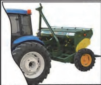
Kombine ekim mibzerinin traktöre askılı düzen bağlantı şekli / 3 point connection of seed planter / Транспортное положение комбинированной сеялки с навесным креплением.
