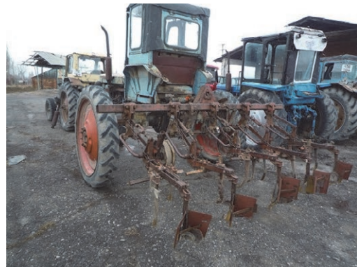
Культиватор Автомобильные бамперы использованы вместо наконечников.
