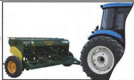
Kombine ekim mibzerinin traktöre çekili düzen bağlantı şekli / Pulled type of seed planter / Транспортное положение комбинированной сеялки с прицепным креплением.
