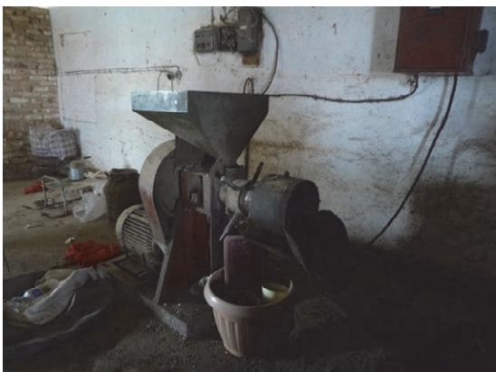
Масловыжиматель (электрический) Таласская область, район Бакаята, частный фермер
