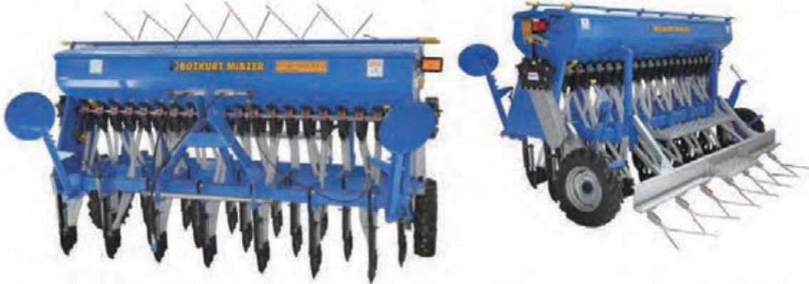
Yapı olarak, lama üzerine bağlanmış ayak saçlarına perçin veya kaynakla çelik dökümlerin bağlanması ile oluşan parçalardır. Bu tip ayaklarda eşit ekim derinliği ayarlamak mümkündür. Sıra ara mesafesi: 100 mm - 125 mm olarak imalat yapılmaktadır. Uçtan Yaylı Balta Ayaklı Makinalarda ayaklar 3 sıra şasi üzerine bağlanmaktadır.
