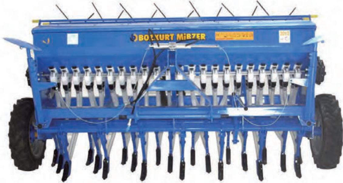
Yapı olarak, kare demir üzerine bağlanmış ayak saçlarına perçin veya kaynakla çelik dökümlerin bağlanması ile oluşan parçalardır. Bu tip ayaklarda eşit ekim derinliği ayarlamak mümkündür. Sıra ara mesafesi: 125 mm olarak imalat yapılmaktadır. Yaylı Balta Ayaklı Makinalarda ayaklar 3 sıra şasi üzerine bağlanmaktadır.
