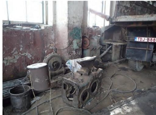
鍛造設備 電動ブロワー（ふいご）と金床。中央部にベンチグラインダーが設置されている
