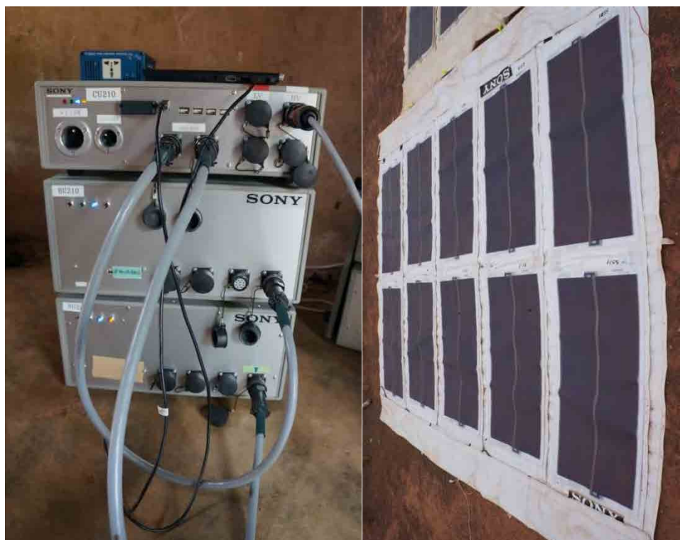
写真 3 ソニーCSL 開発の蓄電システム(左)、富士電機製 PV パネル(右)
