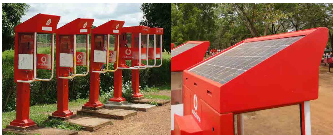
写真 12 ソーラー発電による携帯公衆電話 (Vodafone)
