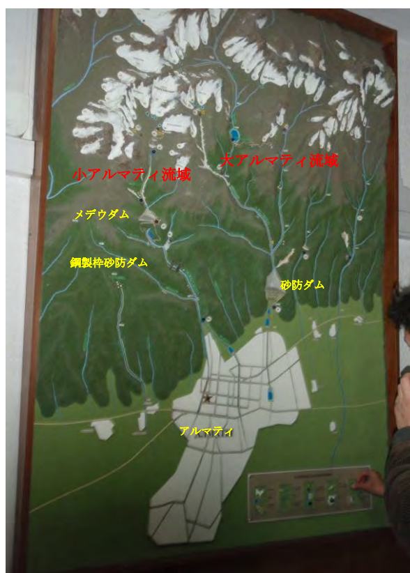
図 10.3 アルマティ市周辺の砂防施設模型図（Kazselezashita アルマティ支局にて）
