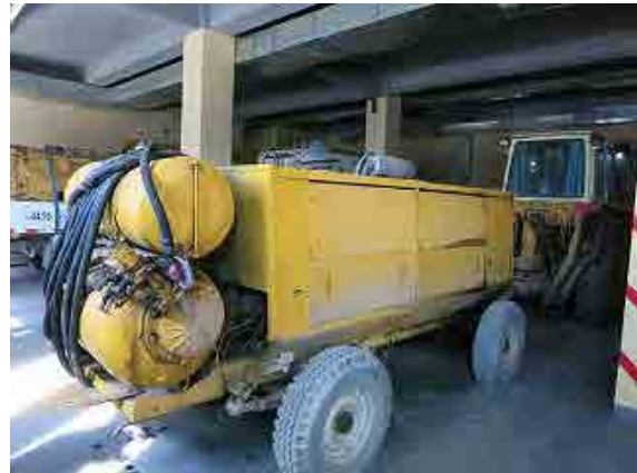
路盤掘削車両（ケーブル事故点発見に使用）
