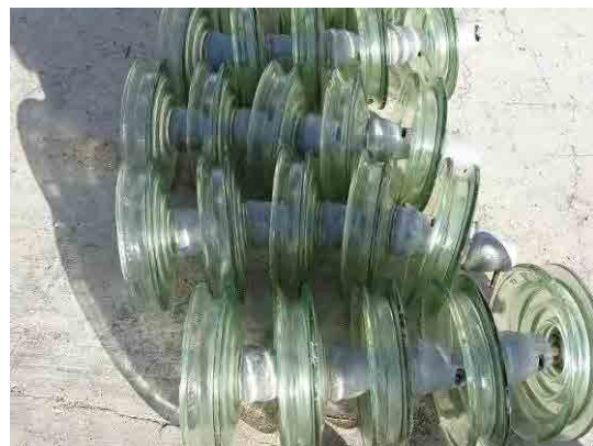
図 4-3 ガラス製がいし（左：ロシア製、右：中国製）
