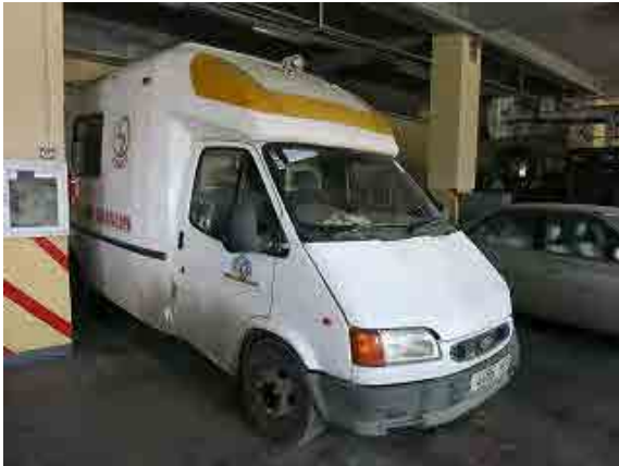
ケーブル事故点探査車。ドイツ製
