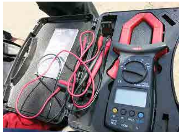
マルチメータ 電圧・電流・抵抗測定
