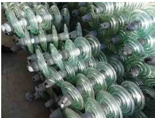
図 4-3 ガラス製がいし（左：ロシア製、右：中国製）
