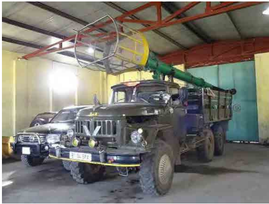
高所作業車（ロシア製、バガヌール支社）
