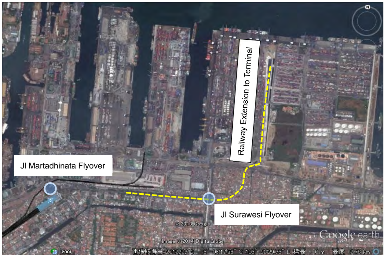
図 5.1.1 タンジュンプリオク港のコンテナターミナルへの鉄道線の延伸
