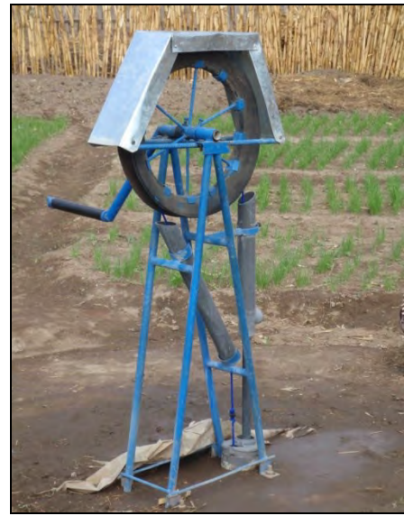
図 2-11 IDE : Zwai の設置ロープポンプ
