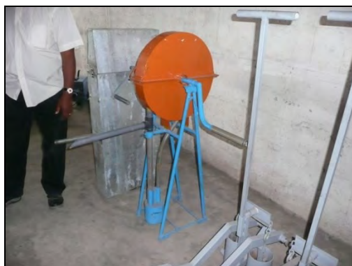
半密閉型ロープポンプ（手前）と 全密閉型ロープポンプ（奥）
