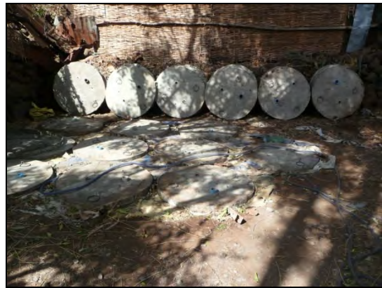
AH-ロープポンプ標準スラブ（アムハラ州）
