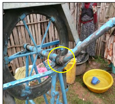
折損したハンドルを村民が溶接
