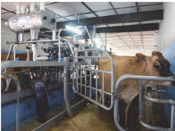
LDB ダヤガマ牧場に導入されたミルクングパーラー。1 回につき 8-10 分で搾乳が完了する。
