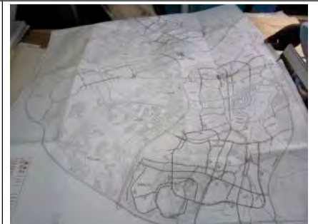
Phase 1の二次配水管網の竣工図
