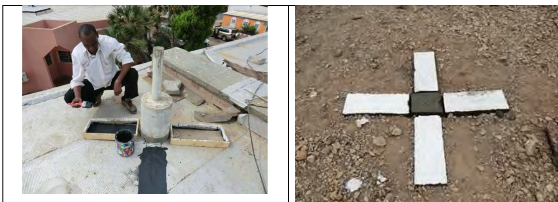
Figure 11 Mise en place de signaux aériens
