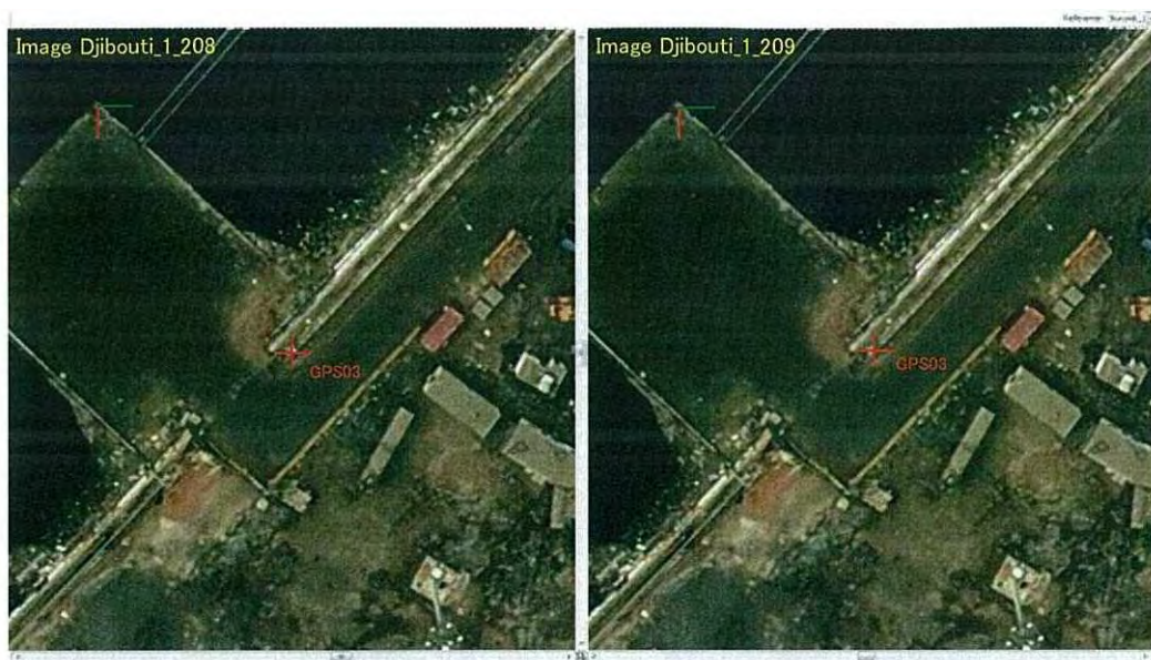
Figure 24 Observation automatique des points de liaison et de jonction
