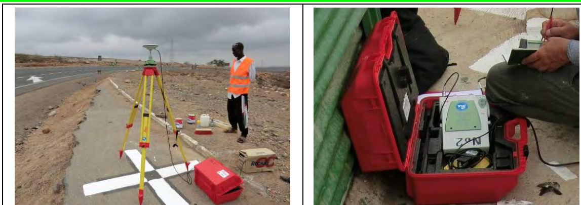
Figure 13 Observations GNSS (à gauche : Observation GNSS, à droite: récepteur GNSS Leica GS10)
