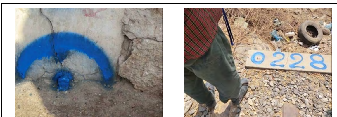
Figure 14 Repères de nivellement existants (à gauche : N° 706, à droite : R.N. 228)
