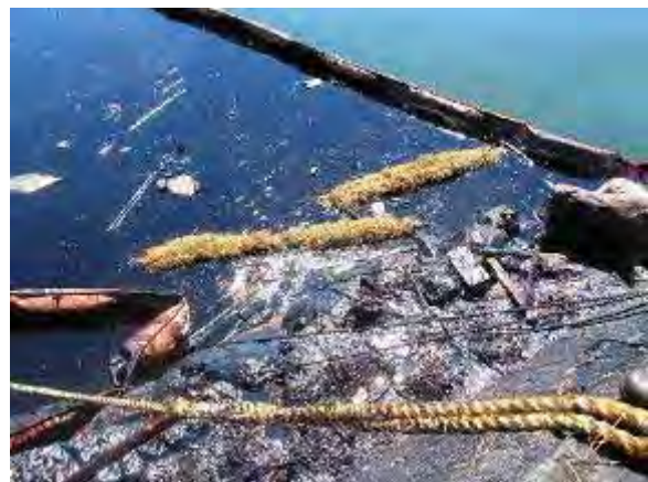
稲わら（左）と抱き枕状に工夫した稲わら製の捕獲材（右）
