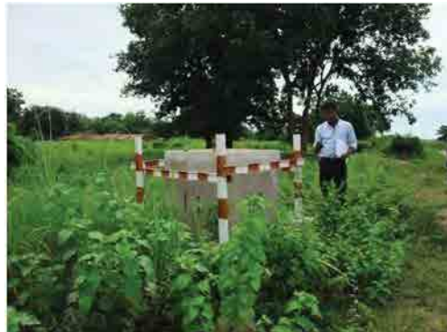
サベ市、Djangbe 地下水位観測井、フロート式自記水位計、S Eau 職員が月 1 回データを回収
