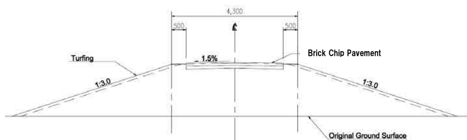
図 3.1 潜水堤防の標準断面
