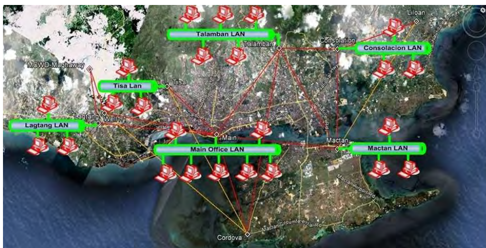
図 3.2.2 MCWD によって現在計画中の通信幹線システム構成図
