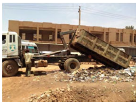
コンテナキャリアーによる収集 市場など1ヶ所で大量の廃棄物が発生する場所で 使用されていることが多い。
