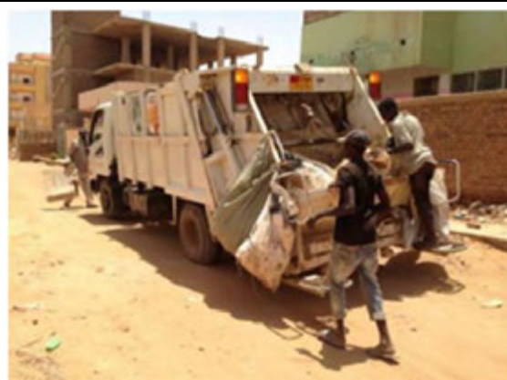
コンパクターによる袋収集 住宅地等を巡回して廃棄物を収集している。
