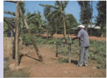
写真上のファームポンドからロープと滑車を利用して貯水を汲み上げる。
