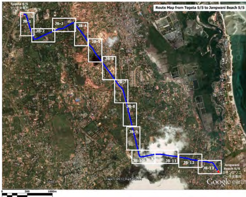
DWG No. DL-R-01 Route Map of Distribution Line (Key Plan) Jangwani Beach Substation – Tegeta Substation (6.5km) 33kV 配電線ルート図(Key Plan) テゲタ変電所 - ジャングワニビーチ変電所間 (6.5km)
