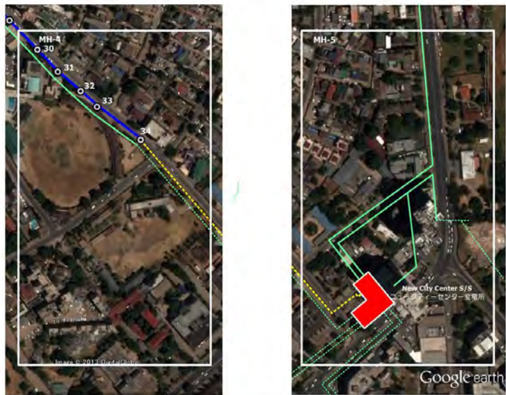
DWG No. DL-R-02-01 Route Map of Distribution Line-1 Muhimbili Substation – New City Center Substation (2.0km) 33kV 配電線ルート図-1 ニューシティーセンター変電所 - ムヒンビリ変電所間 (2.0km)
