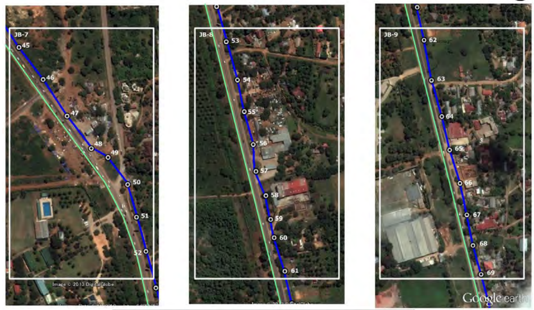
DWG No. DL-R-01-03 Route Map of Distribution Line-3 Jangwani Beach Substation – Tegeta Substation (6.5km) 33kV 配電線ルート図-3 テゲタ変電所 - ジャングワニビーチ変電所間 (6.5km)
