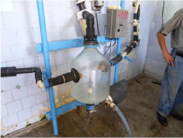
写真 2-14 パイプラインミルクラーの自動洗浄
