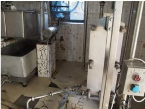
写真 2-24 受入時の計量用槽(左)と冷却用プレート式熱交換器(右)
