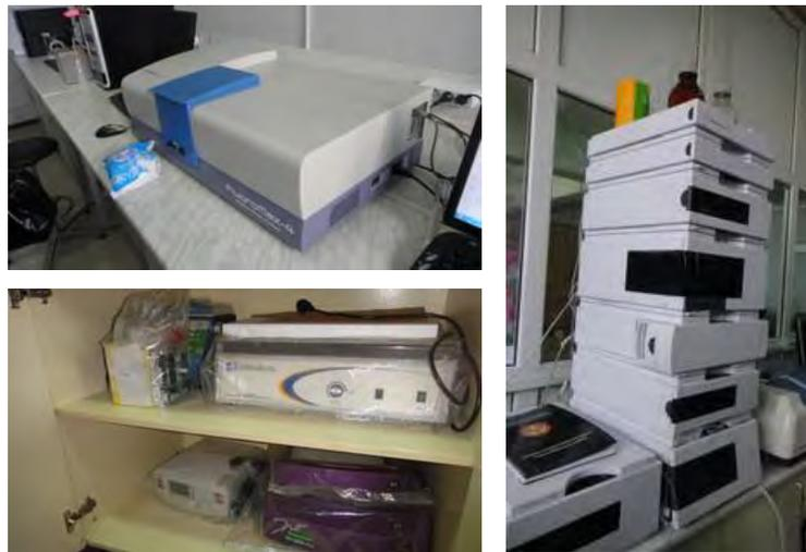
写真 7-6 キルギス・トルコ・マナス大学(分光光度計や PCR、HPLC などの分析機器)
