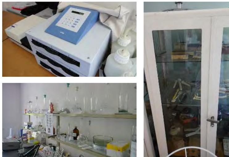
写真 7-3 獣医診断ラボ(マイクロプレートリーダー、寄生虫検査機器など)
