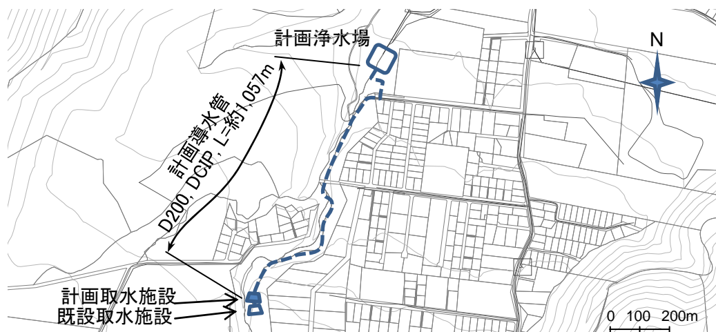
図 3-2-6 取水施設及び導水施設の改修配置図（ヴァイリマ給水区）
