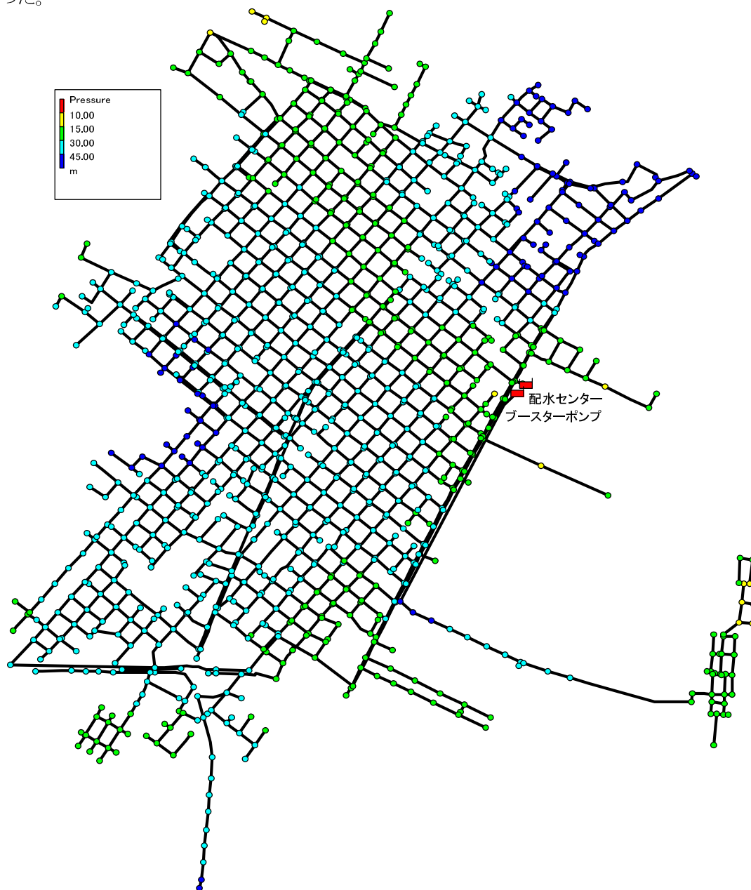
図 6.5.8 改善後の水圧分布図
