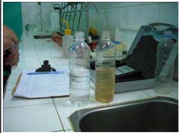
No.8 原水とろ過水の様子
