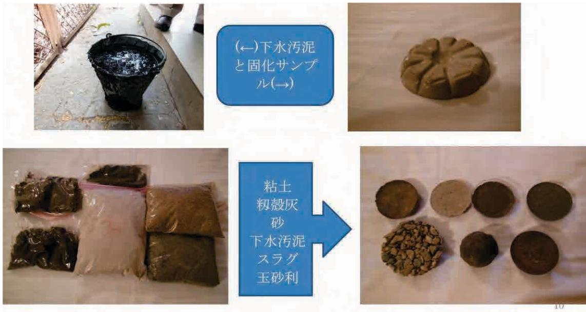
図 入手した原料サンプルとそれぞれ単独での固化試験（現地）
