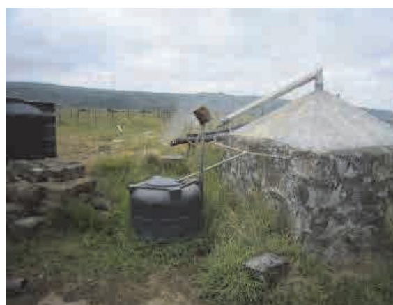
カルデラ内に設置された地熱蒸気からの凝縮水採取設備
