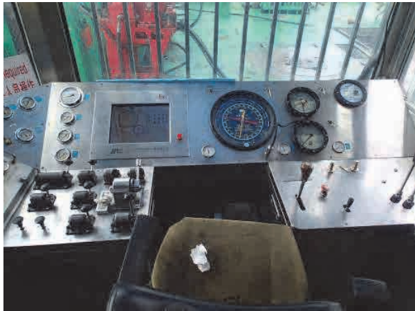
マーチンデッカーとトルクメータしか正常に機能していない。
