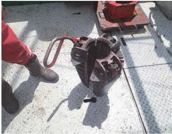
DP スリッパのハンドルが破損
