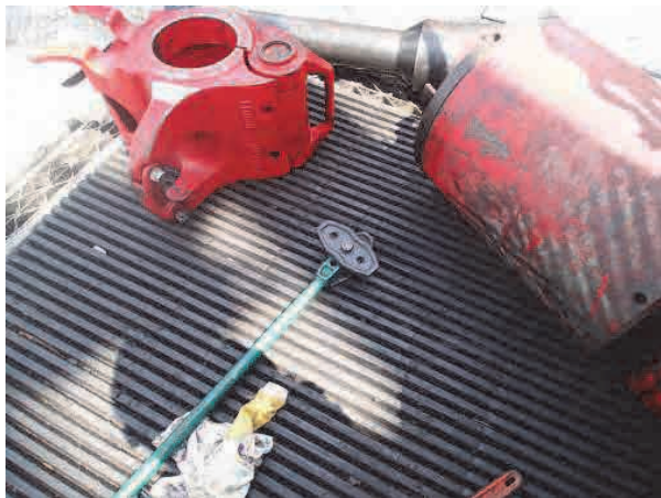
破損したトングのチェーン
