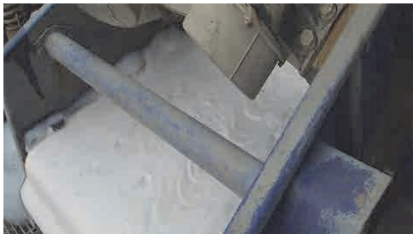
サンドシェーカーにて分離されるフォーム。フォームドリリングの泡にしては量が少なすぎるように思える。
