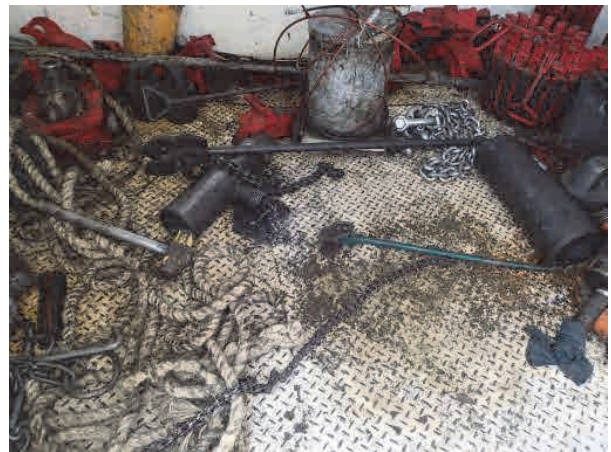
破損したトングのチェーン
