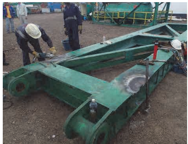
取り扱いの不備によりフレームが変形
