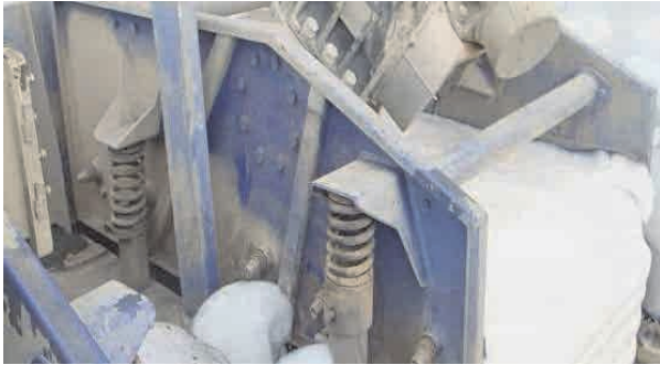
サンドシェーカーにて分離されシューターに落ちている泡と掘削屑
