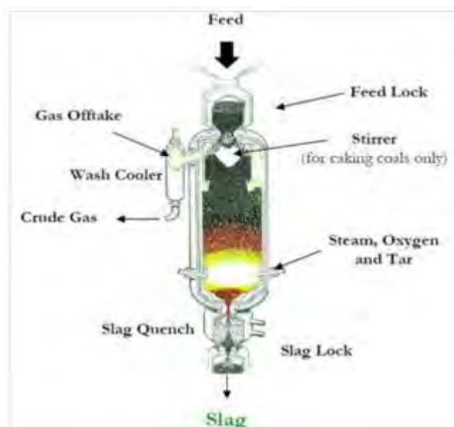
図 R-51 BGL/Lurgi スラッキングガス化装置
