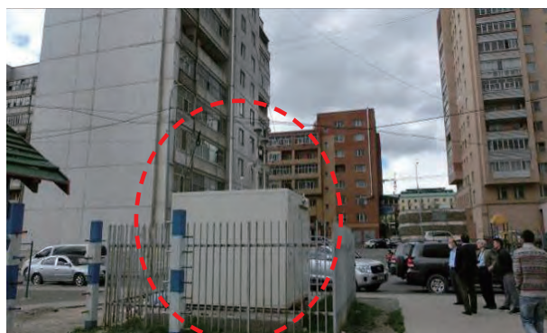
CLEM 測定局 (No. 4); フランス供与、Environnement S.A 製、PM10 測定は \beta 線吸収法
