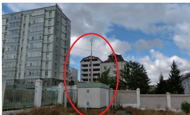
AQDCC 測定局 (No. 3); ドイツ供与、HORIBA 製、PM10 測定は光散乱法
