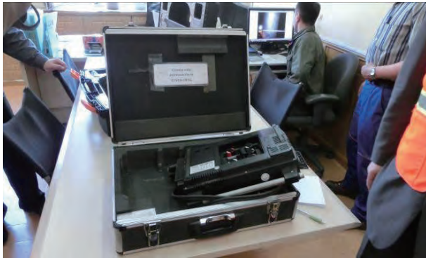
簡易排ガス測定装置 (TESTO)
