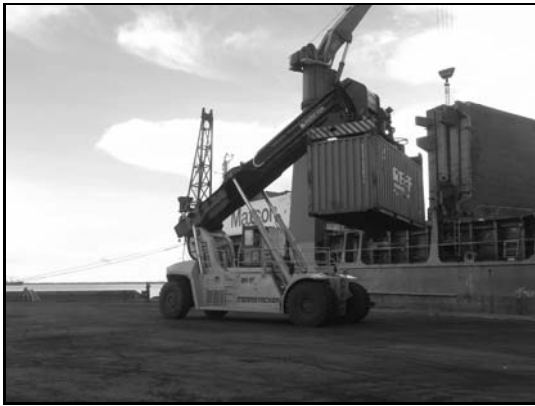
写真-13 リーチスタッカーによる荷役状況
