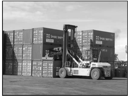
写真-14 トップリフターによる荷役状況
