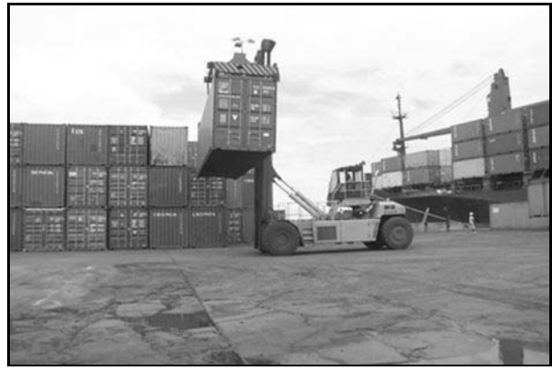
写 2.2.2-2 トップリフターによるヤード荷役状況
