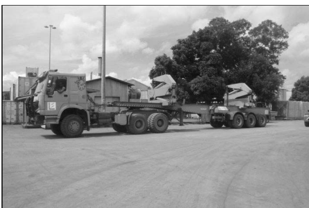
写 2.2.2-3 サイドリフター装備のトラックと積降し作業
