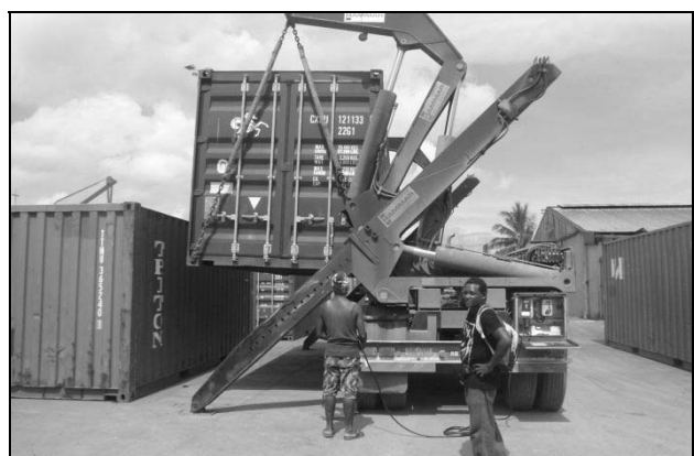
写 2.2.2-3 サイドリフター装備のトラックと積降し作業
