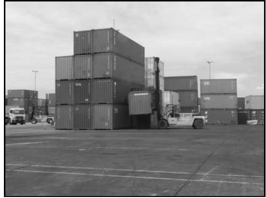
写真-12 サイドリフターによる荷役状況
