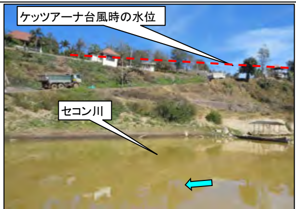
写真-7 : ケツアーナ台風時のセコン川最大水位
