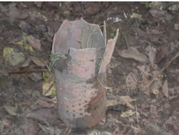
耕耘機に巻き込み破損したチューブ
