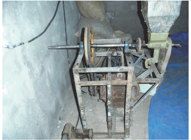
養魚家が手製した餌料粉碎機
