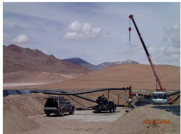
Pozo SM-4 durante el registro estatica de PTS
