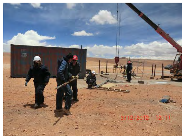
Armando la heramiente para el registro de PTS en le pozo SM-3
