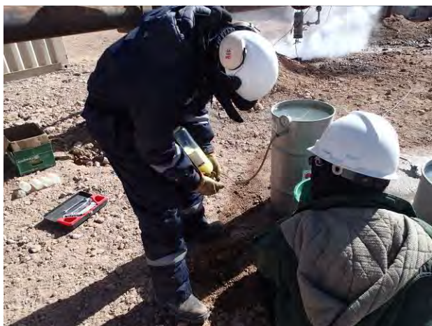
Muestra de gas recogido en el pozo SM-2
