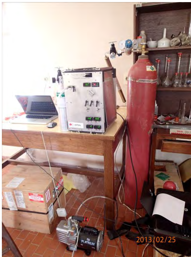
Cromatógrafo para el TFT, bomba de Nitrógeno de alta pureza, bomba vacío
