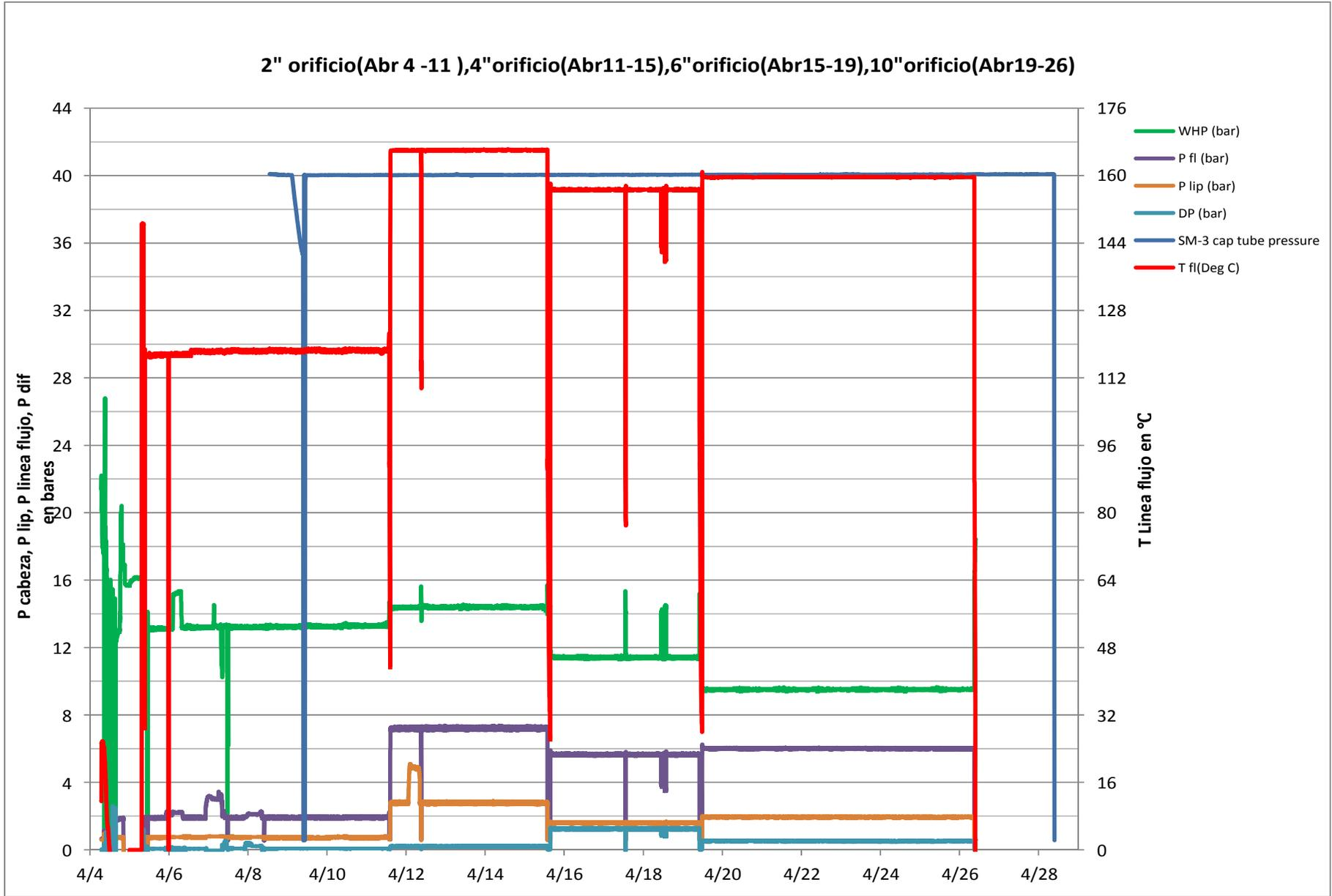
Figura 4-30 Resultado de prueba de producción en SM-2
