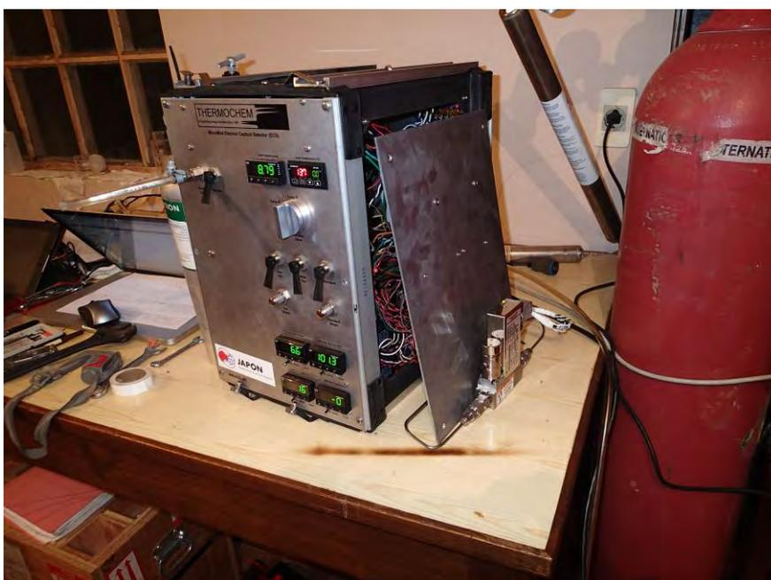
Figura 4-57 Cromatógrafo de gases TFT, usando el controlador de flujo de gas de otro equipo
