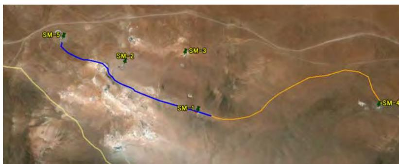
Figura 4-16 Ruta de la tubería de reinyección del pozo SM-5 al pozo SM-1 conceptualizada después de la primera misión
