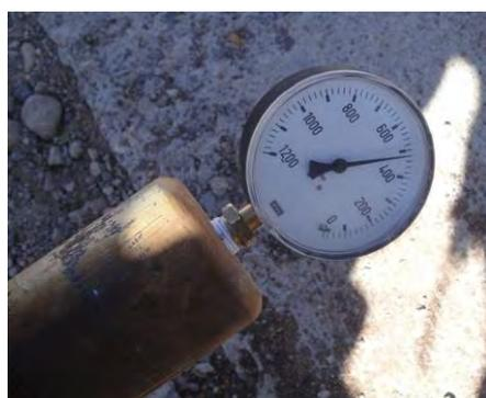
Figura 4-14 La lectura del medidor de vacío durante la reinyección utilizando el método del sifón
