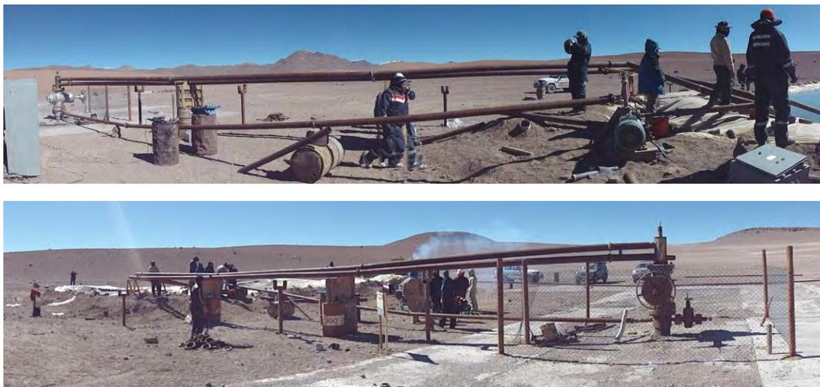
Figura 4-13 Configuración en campo de la prueba de inyectividad utilizando el método del sifón
