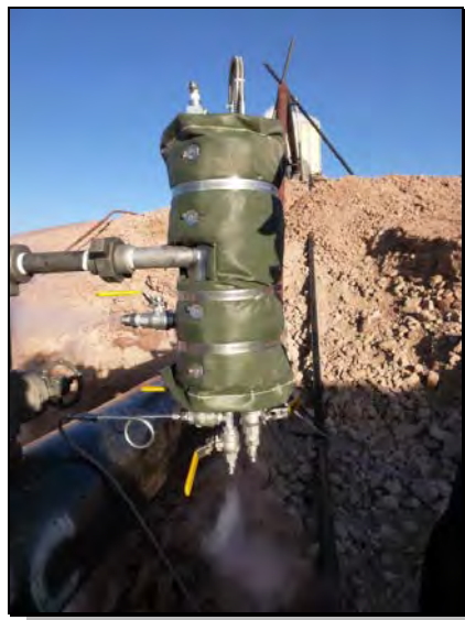
Figura 2: Equipo de separación para toma de muestras.
