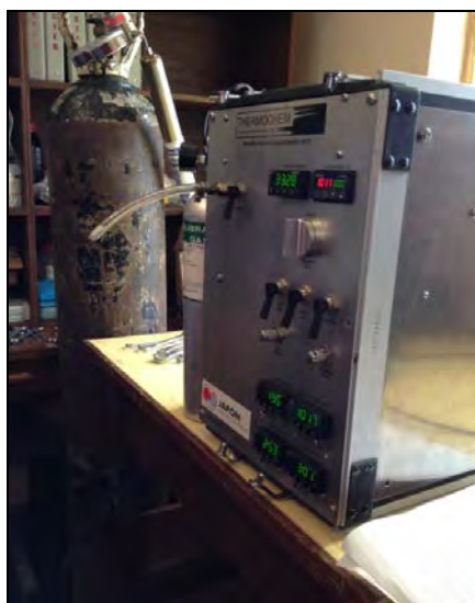
Figura 5: Cromatografo de Gas Acoplado a DCE
