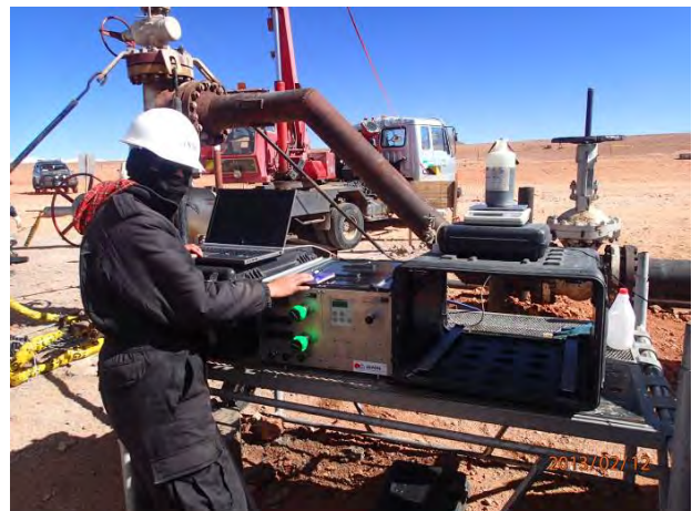
TFT トレーサーの注入作業状況
