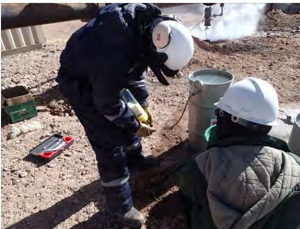
SM-2 の噴気試験中のガスサンプル採取状況
