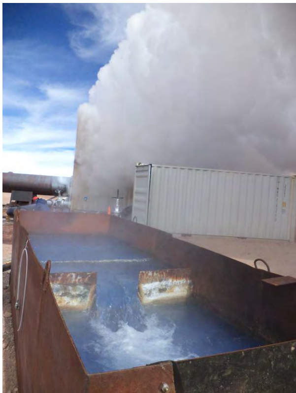
SM-3 噴気試験中の熱水堰の状況
