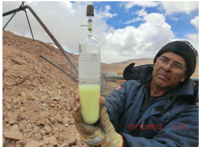
ミニセパレータで採取したガスサンプル
