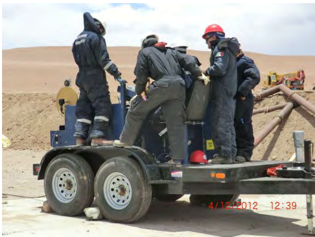
PTS 検層用のスリックラインウィンチの運用
