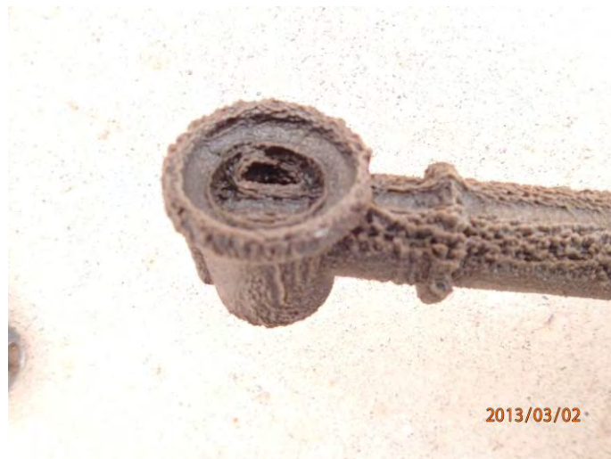
ボルテックス熱水流量計のセンサーに付着したスケール
