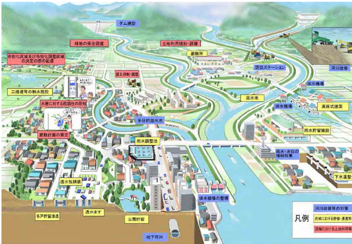
図 3-3 図 3-1 総合的な防災対策の概念図（洪水対策の事例）
